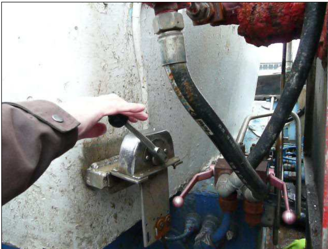
Billede 4: Betjeningshåndtag til at køre frem eller tilbage på enten wirespil eller trawlspil
